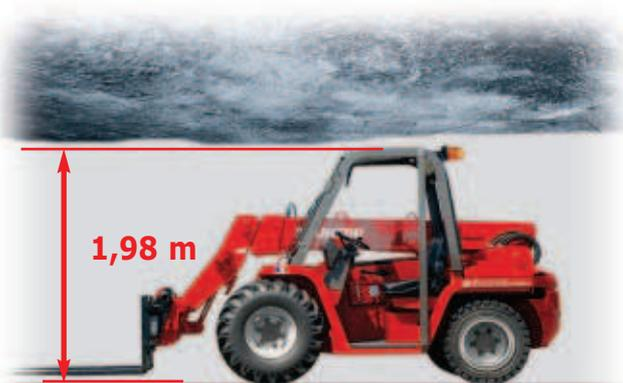
Afin d'accéder aux sites à faible hauteur sous plafond (sous sol, parking souterrain, bâtiments agricoles) la hauteur hors tout du Buggiscopic reste inférieure à 2 m.
