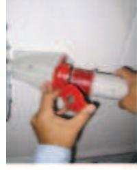
Relier la machine à une prise électrique appropriée.
