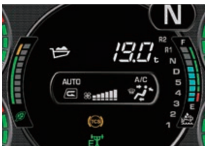
Le compteur de charge utile affiche le poids de la charge
