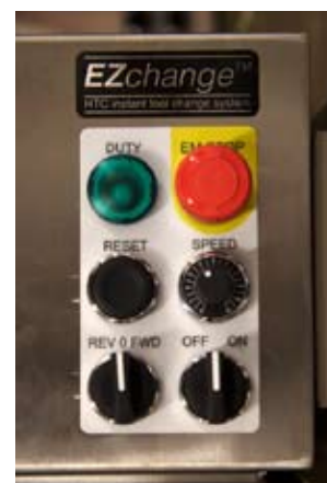
Panneau de commande sur une machine commandée par fréquence
