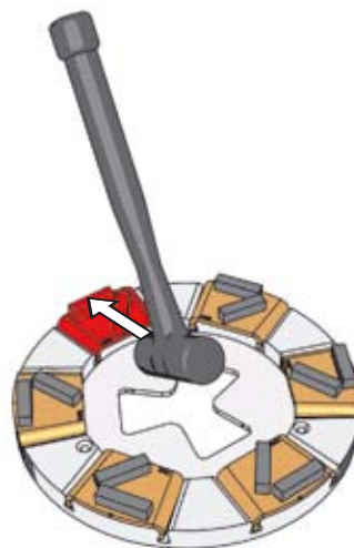
Fig. 2. Ensuite, tapez légèrement pour bloquer l'outil dans le porte-outil, utilisez une massette en caoutchouc.
