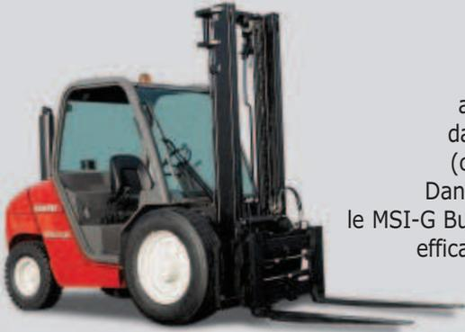
MSI 30 T avec positionneur de fourches
