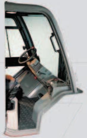
Un monolevier proche du siège regroupe les fonctions d'élévation/descente et d'inclinaison du mât (10°/12°).
