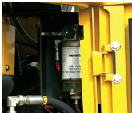
Le préfiltre à carburant avec séparateur d'eau
