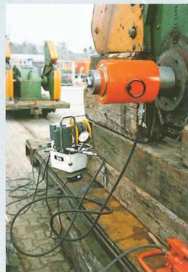
**Centrales hydrauliques à moteur électrique PY 04**
