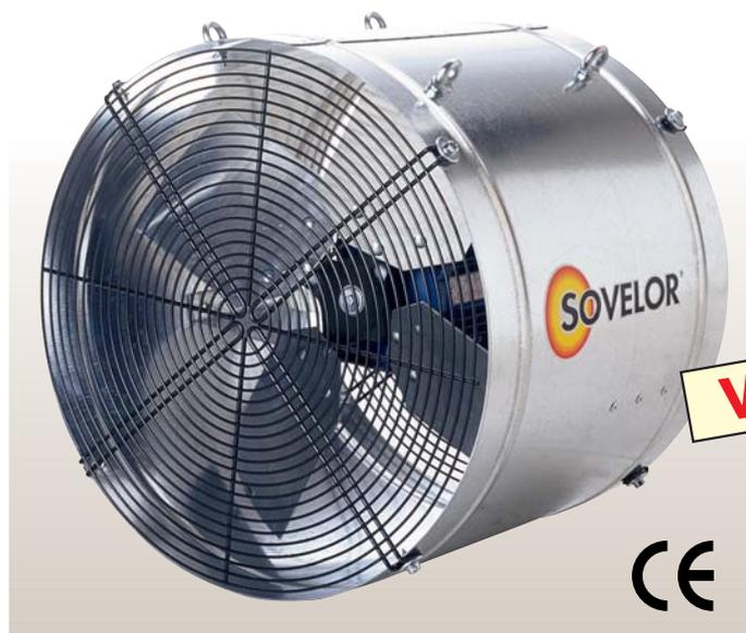
*Le brasseur d'air V470 est un ventilateur hélicoïde cylindrique équipé de grilles d'aspiration et de soufflage. Il s'utilise pour homogénéiser la température dans les bâtiments, les serres, les locaux industriels, les souterrains... Il permet également d'augmenter la portée d'air d'un générateur en prolongeant le*
