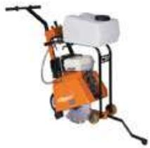
Scie à sol compacte, pour les petits et moyens travaux. Equipée d'un moteur essence Honda de 6,5CV. Avec un disque diamant de 350mm, une profondeur de coupe de 125mm est possible. Volant de descente, kit arrosage de 20 litres.
