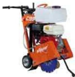
La scie à sol C99 est une machine puissante, et travaille avec peu de vibrations le béton et l'asphalte. Profondeur de coupe de 165mm, carter 450mm, montage possible de 2 disques diamant, moteurs essence de 13CV, diesel de 7CV ou électrique de 7CV.
