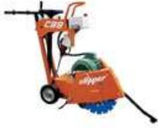
La scie à sol C99 est une machine puissante, et travaille avec peu de vibrations le béton et l'asphalte. Profondeur de coupe de 165mm, carter 450mm, montage possible de 2 disques diamant, moteurs essence de 13CV, diesel de 7CV ou électrique de 7CV.
