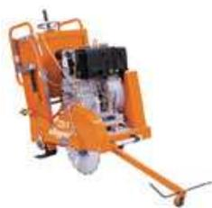
La scie à sol CSW1 est une scie robuste pour les travaux de réparation routière. Equipée d'un disque de 450mm, elle coupe jusqu'à une profondeur de 165 mm dans de l'asphalte ou du béton. Réservoir d'eau intégré de 40 litres.
