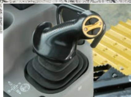
Système ergonomique PCCS (Palm Command Control System)
