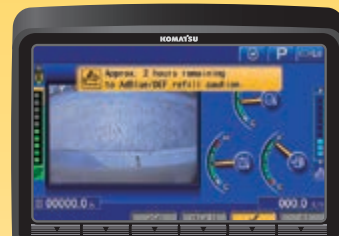
Niveau du liquide AdBlue® et assistance au remplissage
