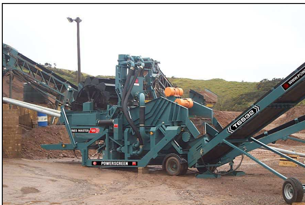
Le Fines Master version mobile en position de travail
