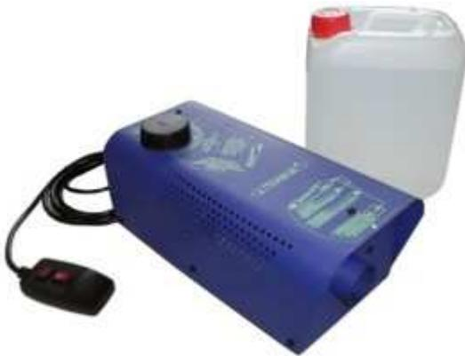
Le pulvérisateur est un appareil robuste et compact ayant la fonction de produire un nuage de fumée dense provenant d'une brume fluide spéciale. Le débit de brume du pulvérisateur s'élève à 90 m<sup>3</sup>/min après un temps d'échauffement de seulement environ 5 min. Il sert surtout à la visualisation de la diffusion de l'air dans les installations de sas et les zones d'assainissement et au contrôle de confinement concernant leur étanchéité.
